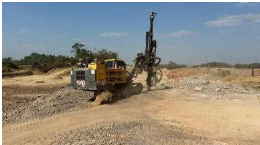
รูปที่ 2.2-5 เครื่องเจาะรื้อระเบิดที่มีอุปกรณ์เก็บฝุ่นติดไว้กับหัวเจาะ
