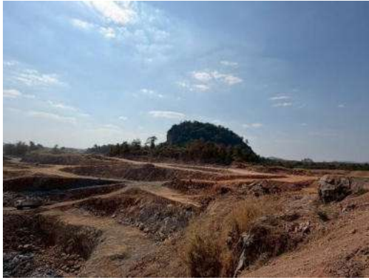
รูปที่ 2.2-1 การเปิดหน้าเหมืองในลักษณะขั้นบันได
