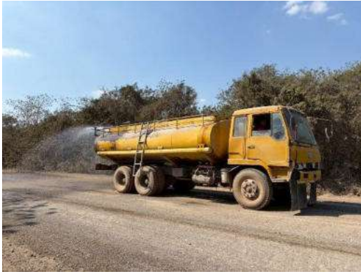
รูปที่ 2.2-6 การฉีดพรมน้ำบนเส้นทางถนนลูกรัง
