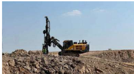
รูปที่ 2.2-5 เครื่องเจาะรื้อระเบิดที่มีอุปกรณ์เก็บฝุ่นติดไว้กับหัวเจาะ
